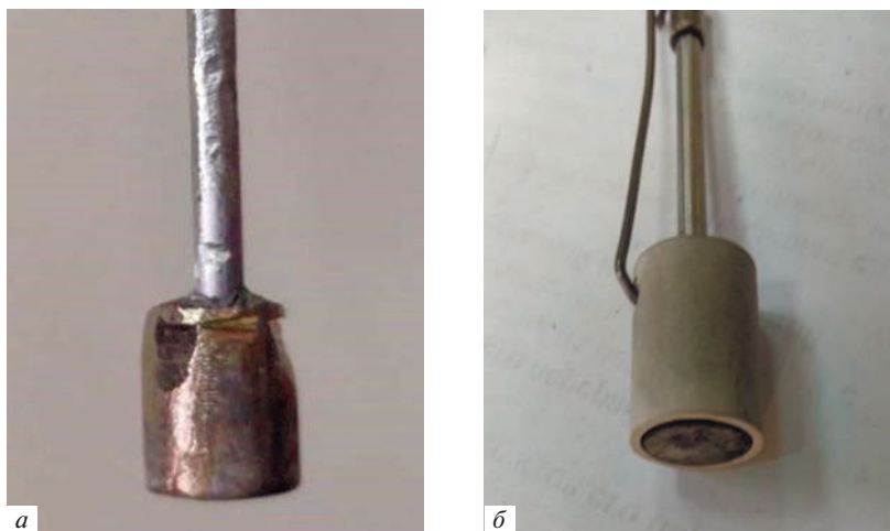
Рис. 1. Внешний вид электродной сборки: а – рабочая часть, б – с трубой из оксида бериллия.
