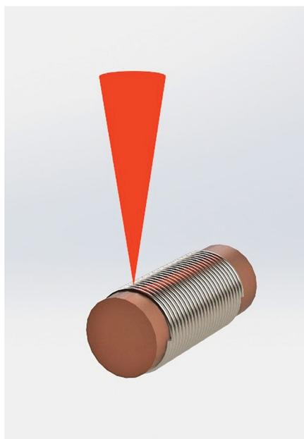
Рис. 2. Стратегия обработки медного стержня по спиральной траектории.
