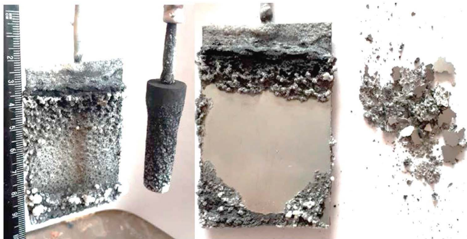
Рис. 4. Молибденовый катод с осадком и графитовый анод после потенциостатического электролиза при потенциале катода 1.6 \text{ В} .
