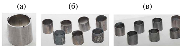
Рис. 1. Внешний вид образцов: а) до испытаний, б) после выдержки 12 часов при температуре 650°С в атмосфере азота, в) после выдержки 12 часов при температуре 800°С в атмосфере азота.
